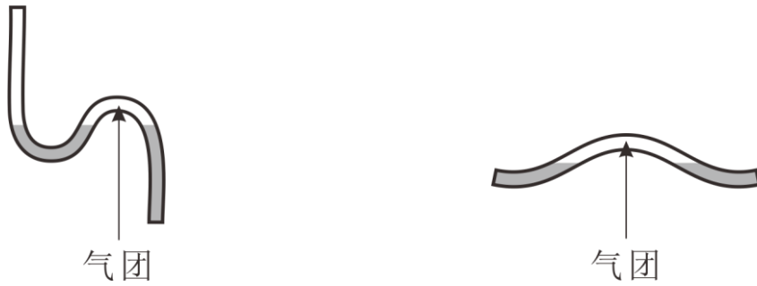
图4 错误的管道连接方法
