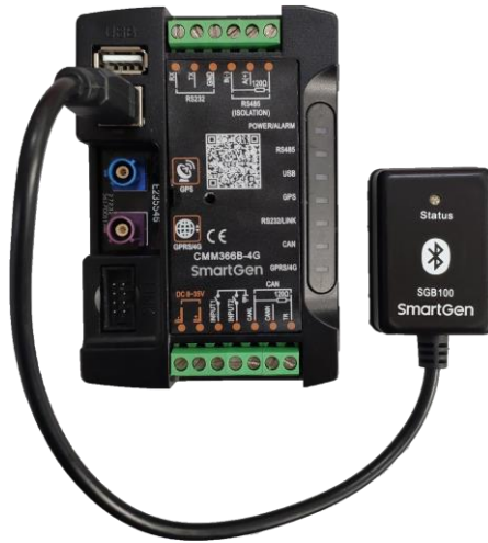
图9 USB 与 SGB100 蓝牙通讯模块连接示意图
