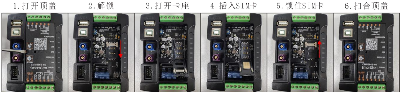
图3 SIM 卡安装示意图
