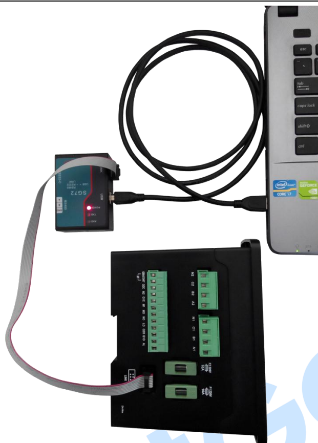
图7 通过 LINK 编程示意图
