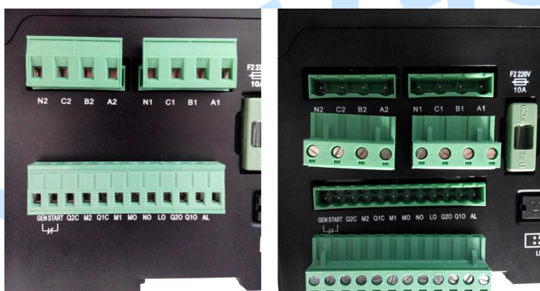
图5 更换端子头示意图
