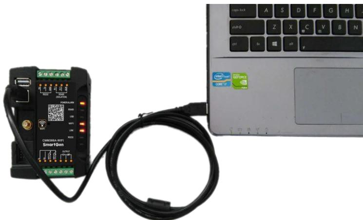
图7 USB 与 PC 配置连接示意图
