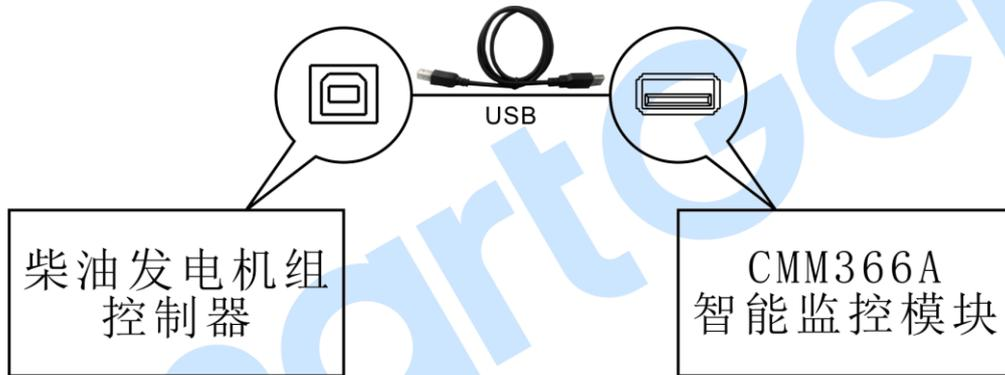
图6 USB Host 连接示意图
