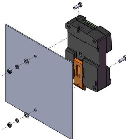
图14 CMM366A-WIFI 螺丝安装方式
