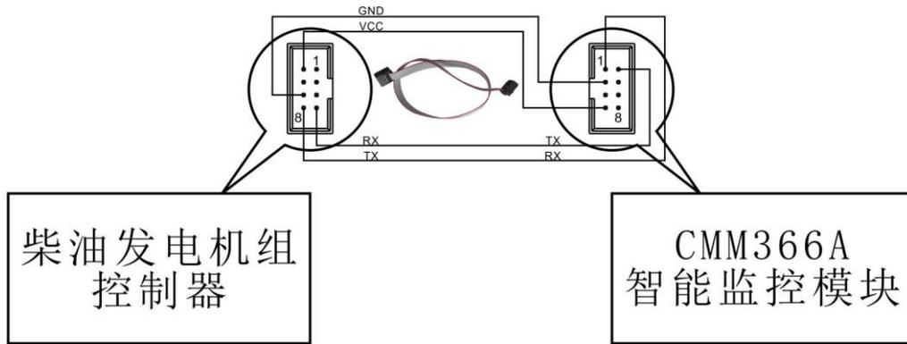
图5 LINK 连接示意图
