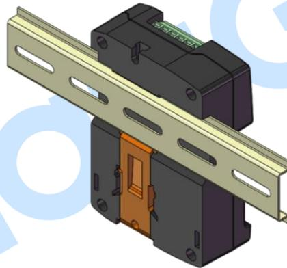
图13 CMM366A-WIFI 导轨安装方式
