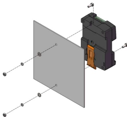
图15 CMM366A-4G 螺丝安装方式
