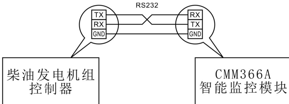
图6 RS232 连接示意图
