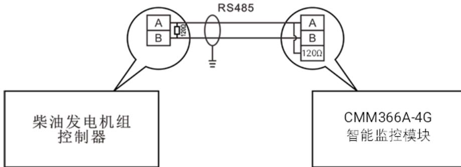
图4 RS485 连接示意图
