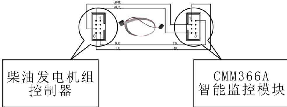
图7 LINK 连接示意图
