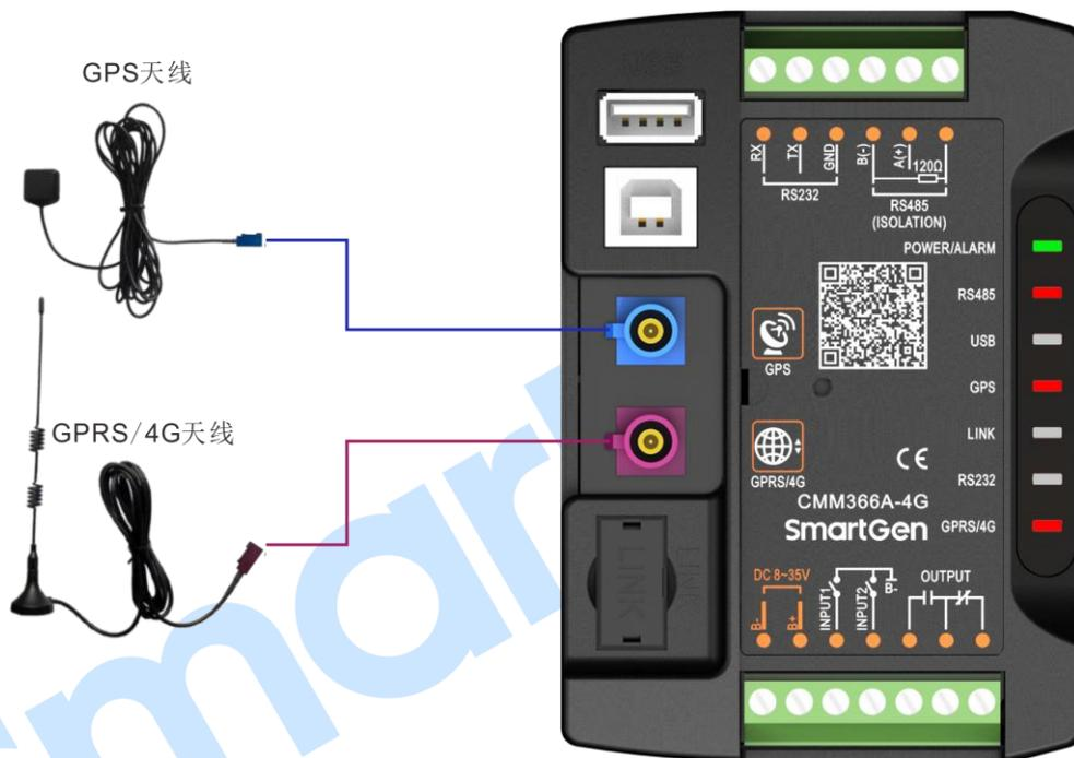
图2 CMM366A-4G 天线连接示意图
