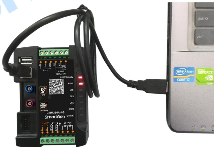
图9 USB 与 PC 配置连接示意图
